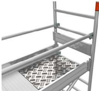
6.1 Längsbordbretter 5 werden gegenüberliegend in der Gerüstinnenseite auf den Belag aufgestellt. Anschließend schieben Sie die Stirnbordbretter 4 stirnseitig zwischen die Längsbordbretter 5.
