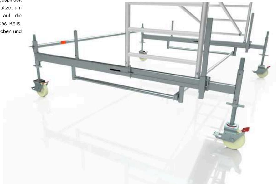
Die Verwendung des Stützrohrs dient ausschließlich zum Umbau der fahrbaren Arbeitsbühnen mit teleskopierbarem Fahrbalken. Während des Umbaus dürfen die fahrbaren Arbeitsbühnen nicht betreten werden. Ein Umbau mit maximaler Ausspindelung ist nicht möglich. Für den Umbau ist die Ausspindelung auf  $L_{Sp} \leq 53$  cm (Abstand Aufstellfläche zu Oberkante Spindelmutter) zu begrenzen.
