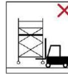
Die Fahrbare Arbeitsbühne darf nicht mit einem Kran, Stapler oder ähnliches angehoben und versetzt werden.
