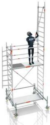
**5.1** Die erste Standleiter **10** aufstecken und mit Federstecker sichern wie in Punkt **4.3**. Hängen Sie jetzt zwei Rückengeländer **1** in die oberste Sprosse der bereits montierten Standleiter **10**. Die zweite Standleiter hängt bereits auf der gegenüberliegenden Seite am Rohrverbinder der ebenfalls montierten Standleiter.
