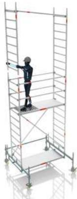
**5.3** Heben Sie die Standleiter **10** nach oben und stecken diese ebenfalls in die Rohrverbinder. Sichern Sie diese Standleiter **10** ebenfalls mit Federsteckern wie in Punkt **4.3**.
