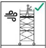
Bei Verwendung im Freien oder in offenen Gebäuden sind die Arbeiten auf der fahrbaren Arbeitsbühne bei Windstärken über 6 nach der Beaufort-Skala sofort einzustellen und bei Arbeitsende in einen windgeschützten Bereich zu verfahren oder durch andere geeignete Maßnahmen gegen Umkippen zu sichern oder abzubauen.
